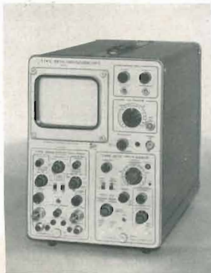
Fig. 4 - Oscilloscopio Tektronix, mod. 561A a campionatura con base dei tempi sino a 0,2 nsec per divisione.
