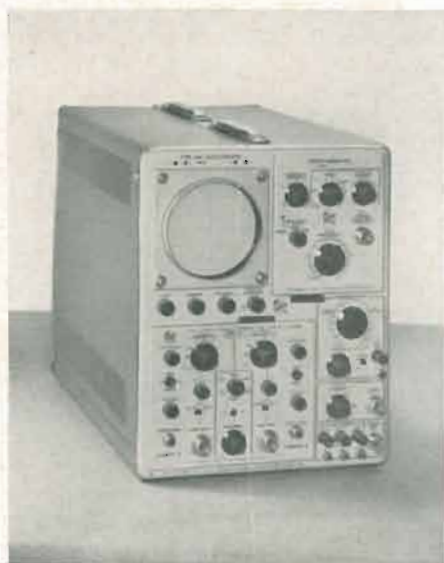
Fig. 5 - Oscilloscopio Tektronix, mod. 661 a doppia traccia e a campionatura con base dei tempi sino a 1 nsec/cm.
